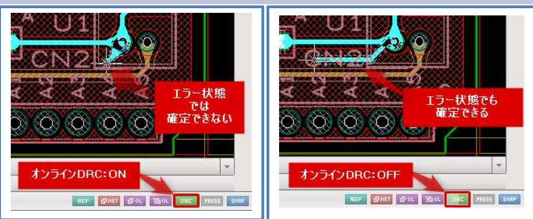
※クリアランスが保てていない場合、違反している箇所が縁取りされて表示されます。
